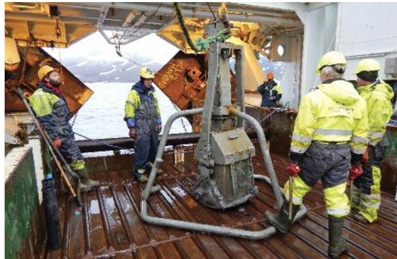
Pobór osadów z dna fiordu Hornsund próbnikiem skrzyniowym na statku „Helmer Hanssen” w ramach naszych badań na Spitsbergenie
